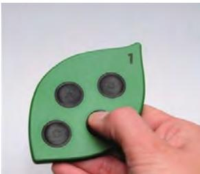
Funktechnik ist heute allgegenwärtig. Alles ist mit allem drahtlos verbunden. Selbst Lichtschalter funktionieren heute ohne Kabel, was vor allem für nachträglichen Einbau in Häusern ein grosser Vorteil ist, entfällt doch das Aufspitzen der Wände. Wenn die Geräte jetzt auch noch die Batterie loswerden, entfallen Wartung und Entsorgung der schadstoffbehafteten Batterie. Dies kann man erreichen, indem man Energie aus der Umgebung gewinnt.
