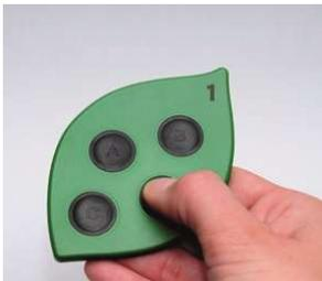
Der Forschungszweig, welcher sich mit dieser Thematik beschäftigt, nennt sich «Energy Harvesting». Dabei werden Licht, Vibrationen, Wärmeunterschiede usw. in elektrische Energie umgewandelt. Dieses Modul zeigt die verschiedenen Möglichkeiten von Energy Harvesting und demonstriert einige Möglichkeiten mit sogenannten Voting-Geräten, welche Quizzes erlauben wie in einer Quizshow, und das alles ohne Batterien!
