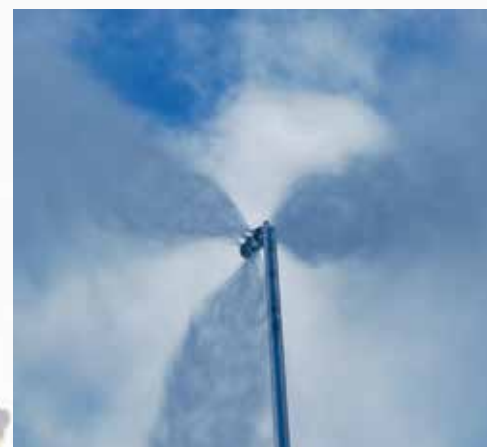
Moderne Schneilanze, die rund 80 Prozent weniger Strom verbraucht als herkömmliche.
