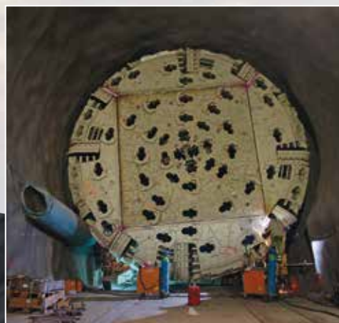
La testa è la parte più importante della talpa meccanica. Per la galleria di base del San Gottardo questa aveva un diametro di 9,58 metri.
