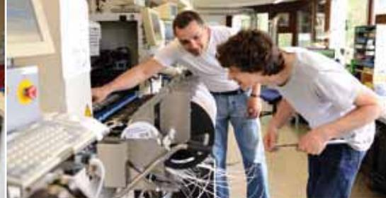
Sulla macchina di assemblaggio i componenti elettronici di un defibrillatore sono collocati su una piastra prima di essere saldati.
