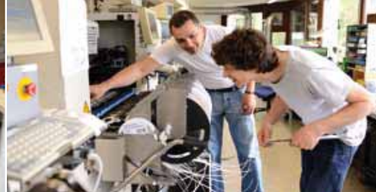
Les éléments électroniques d'un défibrillateur sont placés sur une platine de la machine de placement avant d'être soudés.
