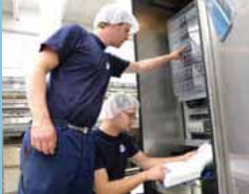
La riempitrice non raggiunge la temperatura desiderata. Mio fratello ed io riciviamo dallo schema elettrico l'indicazione del relais a stato solido.
