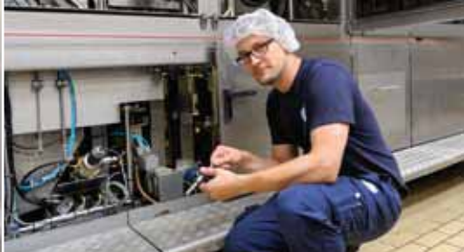
▲ Viene sostituita una vite a ricircolo di sfere per la sigillatura del raccordo del fondo. Io verifico la funzionalità del pezzo di ricambio.
