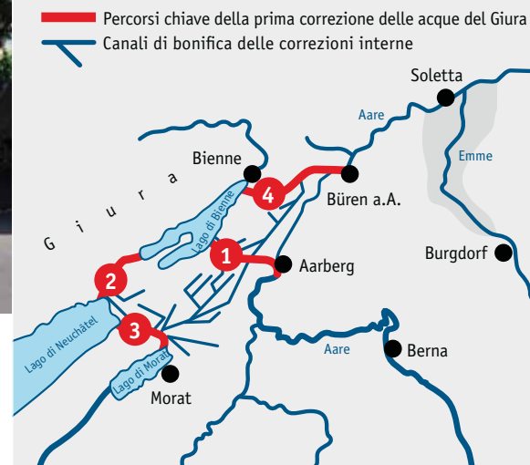
Durante la correzione delle acque del Giura furono costruiti 4 grandi canali: 1: Hagneck ; 2: Zihl ; 3: Broye ; 4: Nidau-Büren
