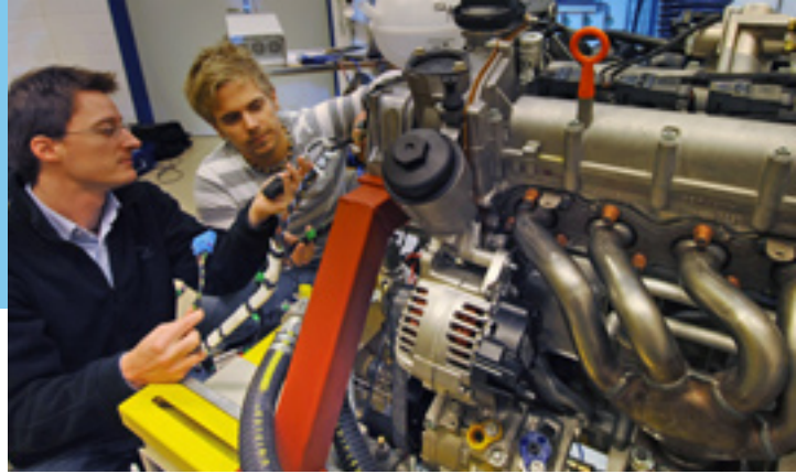
◀ Sieht die Mobilität von morgen so aus? ▶ Motorenprüfstand der EMPA: Hier werden energieeffiziente Motoren und neue Treibstoffe getestet.
